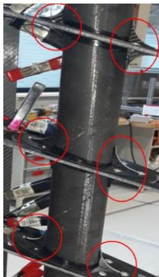
BILD 12: Geklebte und vernietete Flügelrippen [1]
