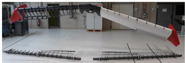
BILD 19: DLR-seitig gefertigte Enerwing-Strukturen; oben: Gesamtanlage mit Winglets von Enerkite GmbH; unten: Ersatzflügelstruktur [1]
