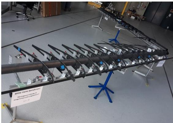
BILD 11: Sandwichrippen mit CFK-Haupt- und Nasenrohrholm im Montagegestell [1]
