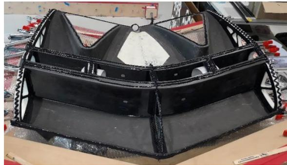
BILD 9: Wingbox und Komponenten [1]
