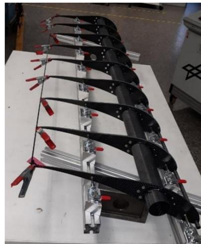
BILD 5: Enerwing-Testsegment in Halbzeugbauweise ohne Bespannung [1]
