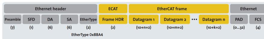
Abbildung 2.7: EtherCAT Datenpaket [25]
