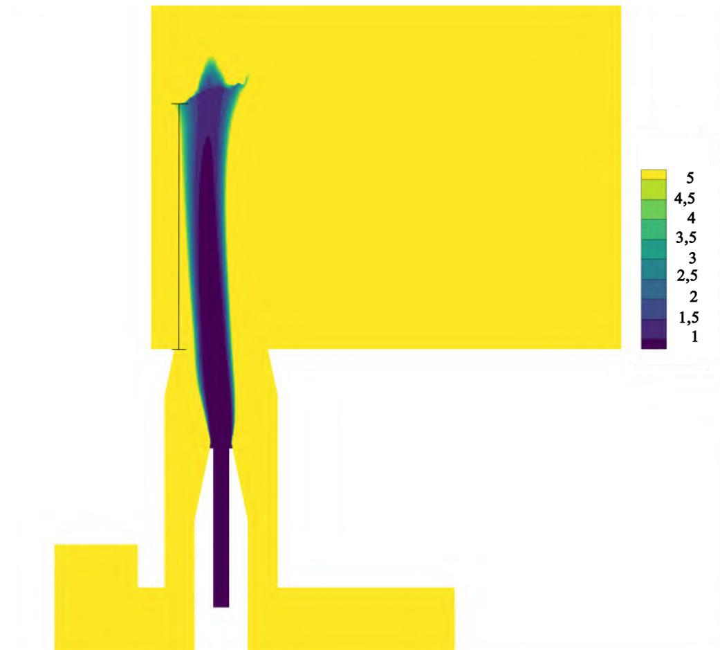
Abbildung 5.6: Verteilung des lokalen Luftverhältnisses des Mittelpunktsversuchs
