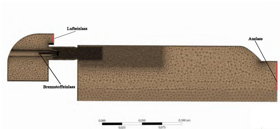
Abbildung 4.2: Rechengitter für die Simulation der reaktiven Brennkammerströmung
