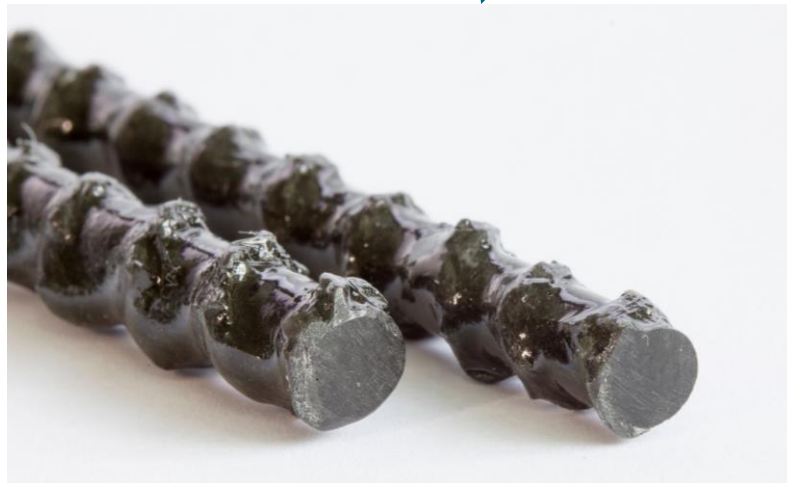
Zaisberg Carbon rCF-Rebar®, der weltweit erste Bewehrungsstab aus rezyklierten Kohlenstofffasern (Foto: Stefan Gröschel, TU Dresden)
