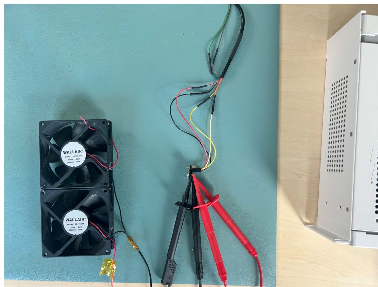
Abbildung 9.13.: Physikalischer Aufbau des Hardwaretests mit Motorsteuerung und Lüfter
