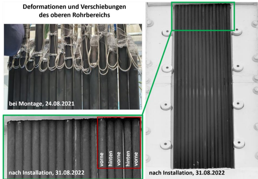
Abbildung 7.6: Fotos des HPMS-II Rohrreceivers bei der Montage durch MAN Energy Solutions (Bildquelle: DLR) sowie nach Installation im MFT (Bildquelle: [MAT22])
