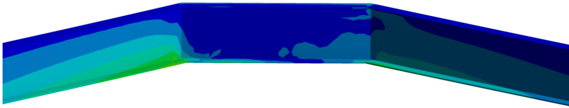
Abbildung 41: Spannungszustand C-Profil ohne Klebefläche
