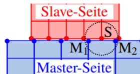
Abbildung 10: Verbundkontakt nicht konformes Netz [27]
