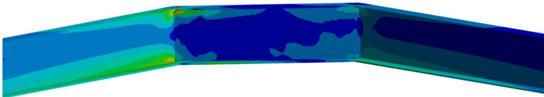
Abbildung 43: Spannungszustand C-Profil mit Klebefläche
