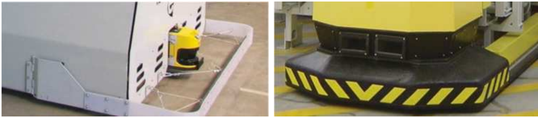
Abbildung 4.33.: Sicherheitslaserscanner mit Aufprallschutz [UA23].
