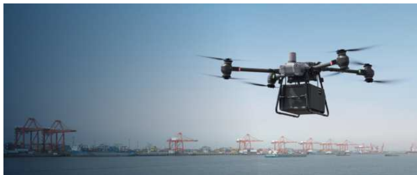
Abbildung 4.21.: Transportdrohne der Firma DJI mit 30 bis 40 kg Nutzlast [DJI24].
