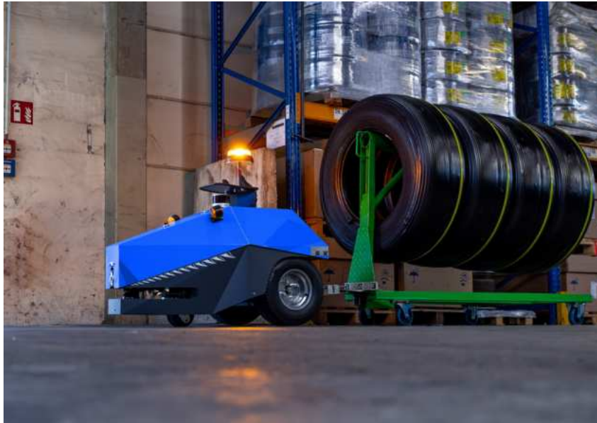
Abbildung 4.22.: Autonomer outdoortauglicher Routenzug der Firma Innoks Robotics [Rob24c].
