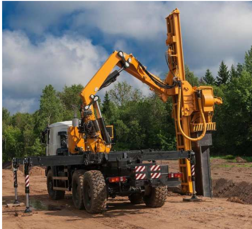
Abbildung 4.4.: LKW mit Baggerarm und teleskopmäklergeführter Ramme [Mag22].
