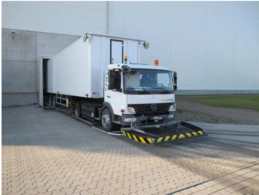
Abbildung 4.14.: Autonomer LKW der Firma Götting KG [KG12].
