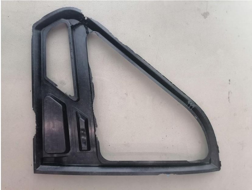
Abbildung 28: Bestes Ergebnis mit Lytex Material (Tür #14) mit Fehlstellen an den Fließwegen, lokal faserangereicherten Stellen und 0,2 bis 0,4mm zu hoher Wandstärke
