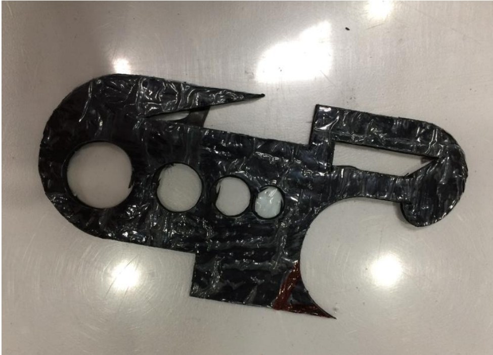
Abbildung 14: Testgeometrie zur Absicherung der Schneidfähigkeit des eingesetzten SMC-Halbzeugs am zu verwendenden Cutter am DLR in Augsburg
