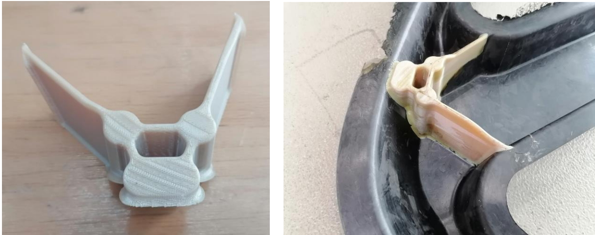
Abbildung 20: 3D-Bauteil (links) bildet die Türscharnier-Aufnahme ab, bei starker Anbindung an das SMC-Material (rechts)
