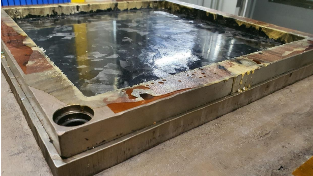
Abbildung 29: Pressplatte mit abzuwiegendem Harzaustritt [FhG IGCV, Augsburg]
