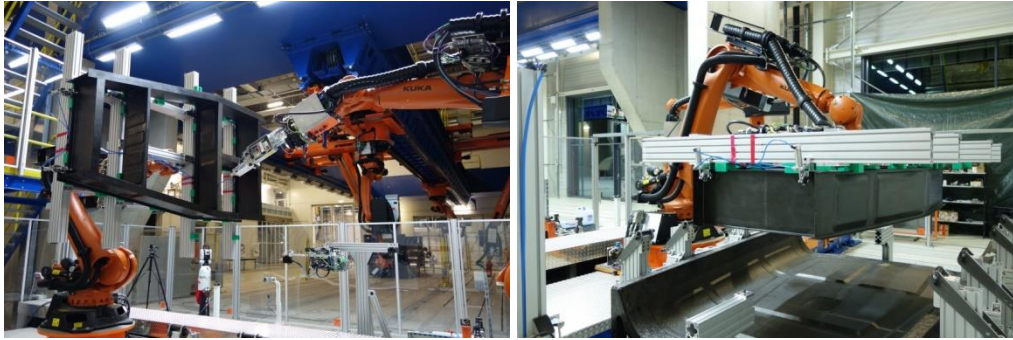
Abbildung 5: Automatisierte Montage einer Hubschrauberbodenstruktur (Larsen & Gänswürger, 2014)
