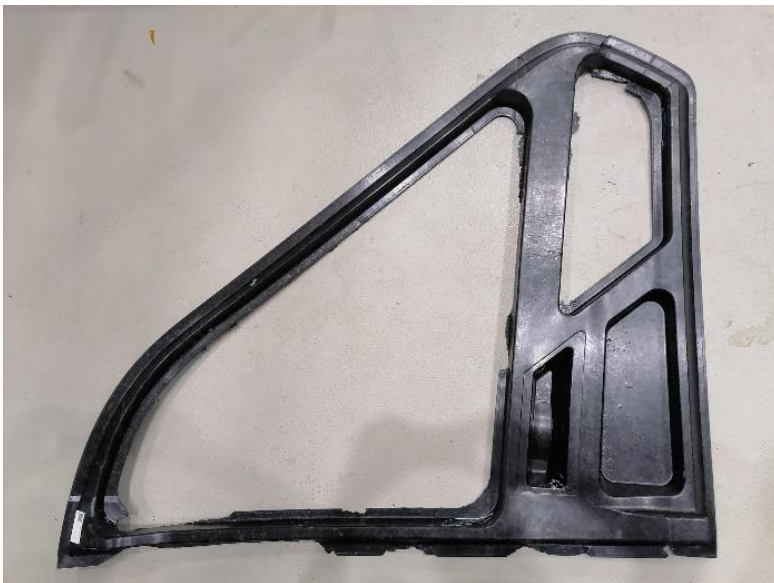
Abbildung 27: Bauteil nach ersten SMC-Pressversuchen am DLR in Augsburg, aus LyondellBasell SMC Material
