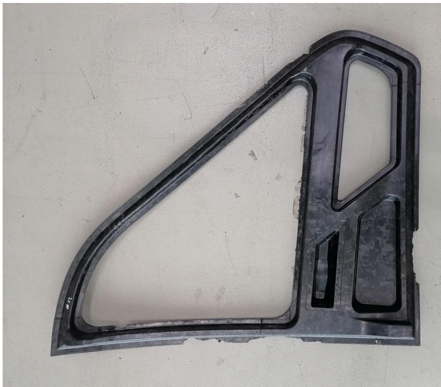
Abbildung 30: Bestes Ergebnis mit Hexcel (Tür #12) mit Fehlstellen an den Fließweg-Enden, lokal faserangereicherten Stellen und bis 0,2mm zu hoher Wandstärke
