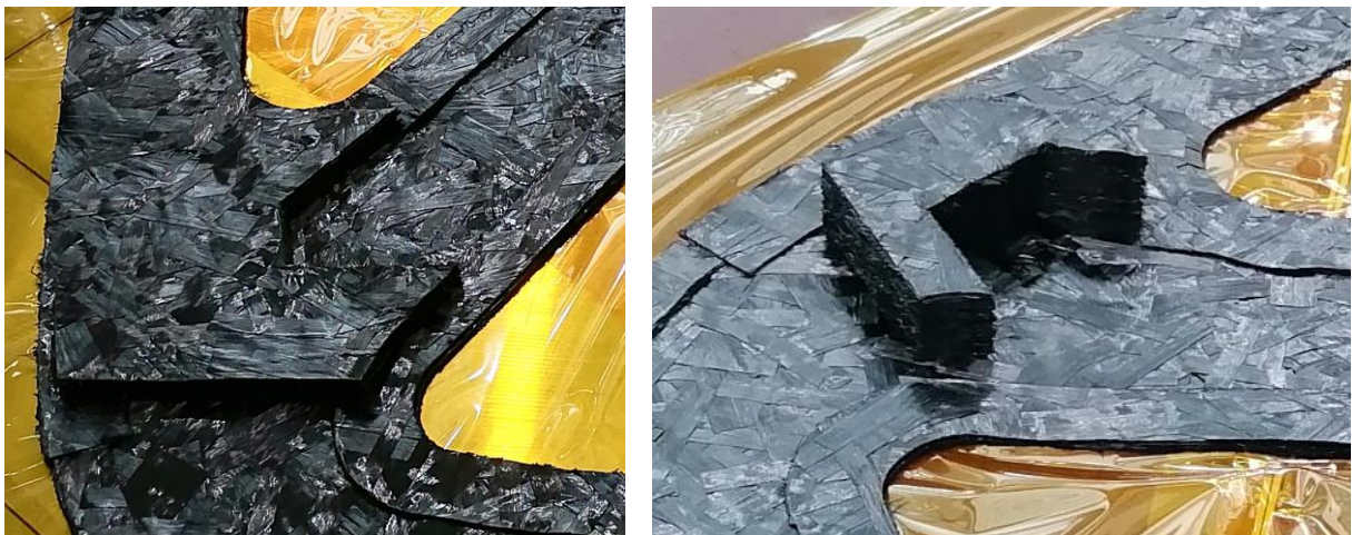
Abbildung 19: Vorpäck im Bereich des Türscharniers, mit sechs großen Lagen (links) und später mit 18 entsprechend kleineren Lagen (rechts), beides bei gleicher Masse
