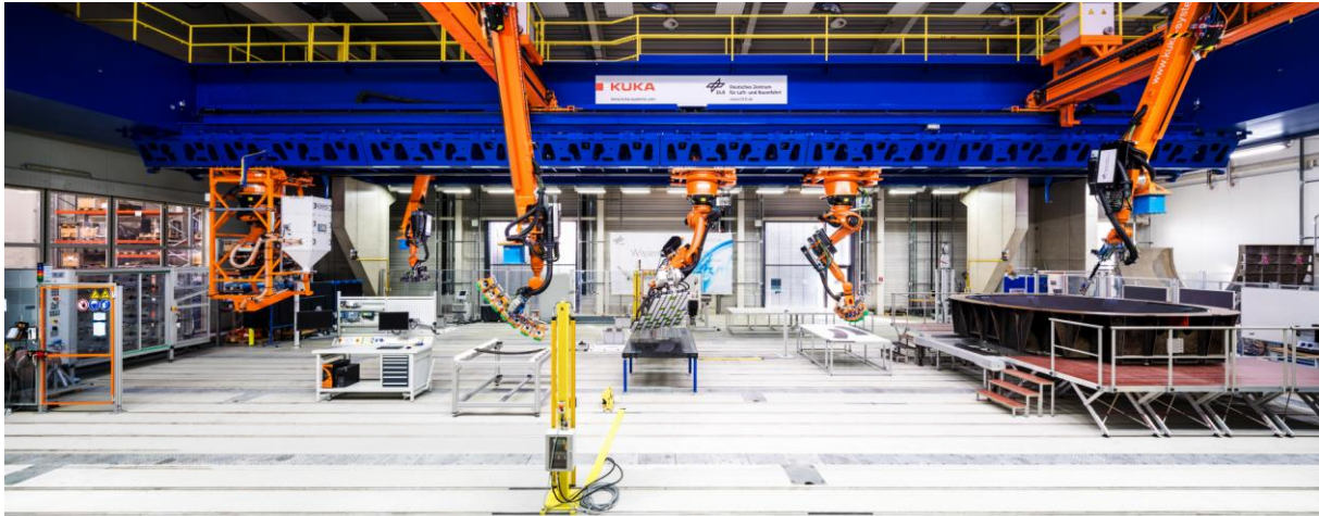
Abbildung 7: Multifunktionale Zelle (MFZ) beim DLR-ZLP Augsburg (30m x 15m x 7m)
