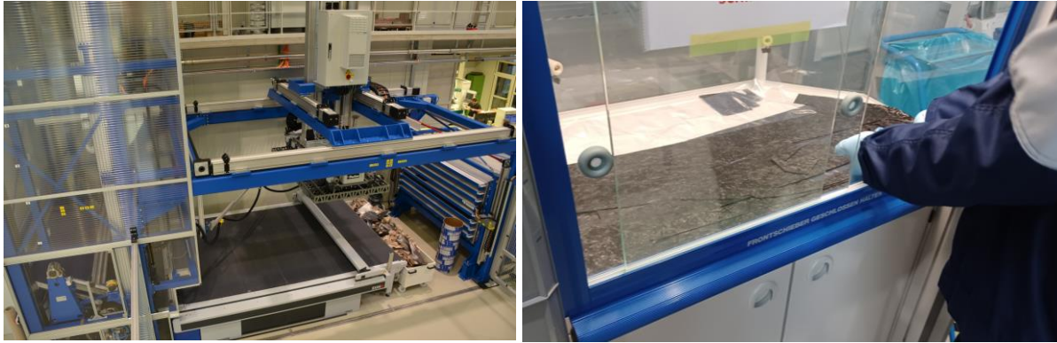
Abbildung 16: Cutter-Zentrum am DLR in Augsburg (links), Vorpack für ein Bauteil im Digestorium
