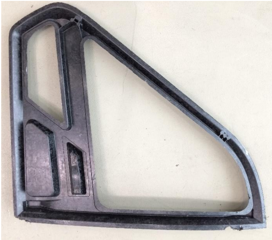
Abbildung 31: Bestes Ergebnis mit Polyth (Tür #22) mit Fehlstellen an den Fließweg-Enden, lokal faserangereicherten Stellen und bis 0,2mm zu hoher Wandstärke
