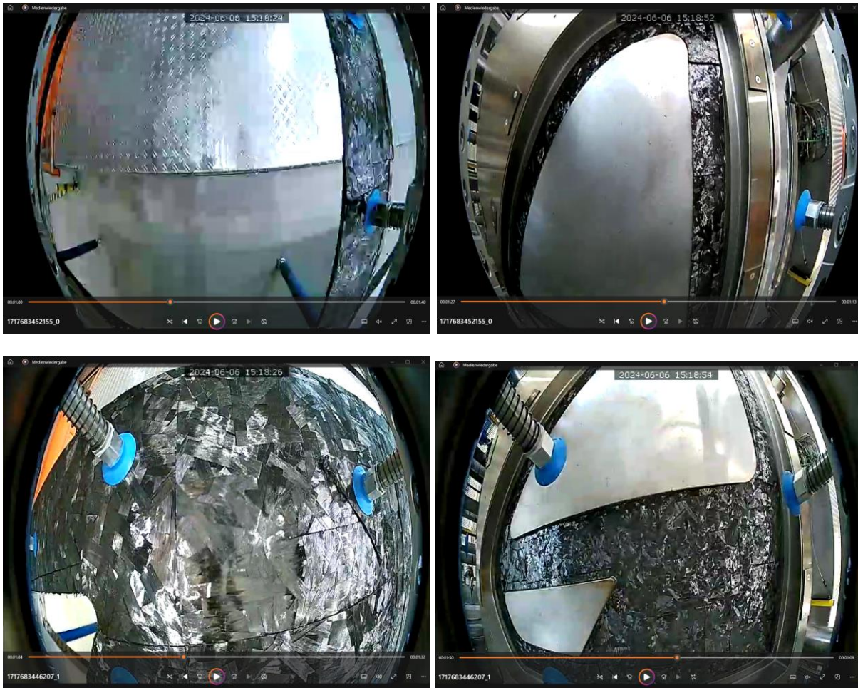
Abbildung 25: Auszug aus der Kameraüberwachung des Endeffektors, Kamera im Fensterbereich (oben) und im unteren Türbereich (unten)
