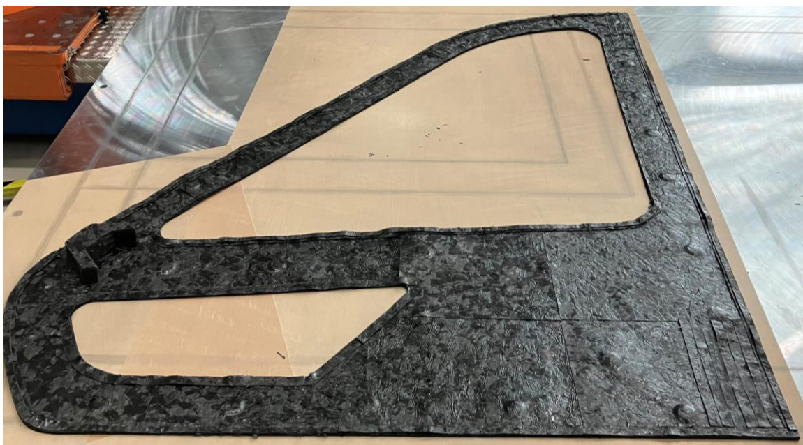
Abbildung 21: Vorpackkonzept mit 15 Grundlagenbereichen, stoßartig aneinander geordnet, für exaktere lokale Gewichtsverteilung, hier aus Polynth Material
