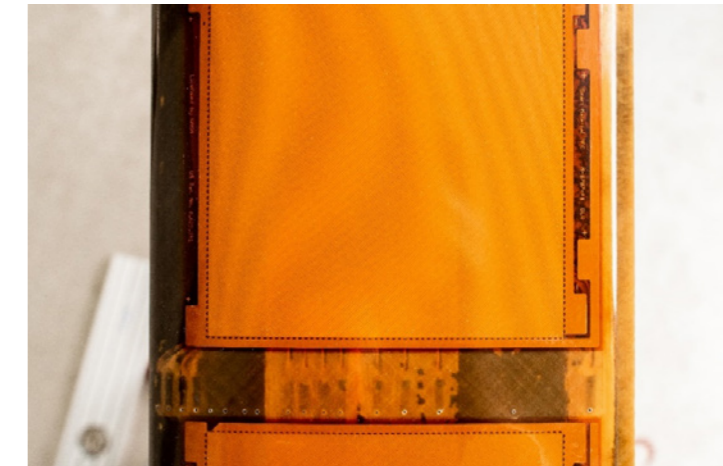
Piezokeramiken und Drucksensoren integriert in die Rotorblattoberfläche Piezo ceramics and pressure sensors integrated into the blade surface
