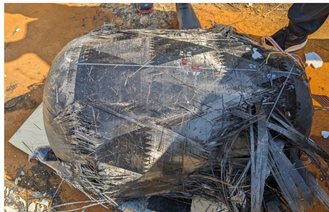
Tank nach dem Berstdruckversuch Vessel after burst pressure test
