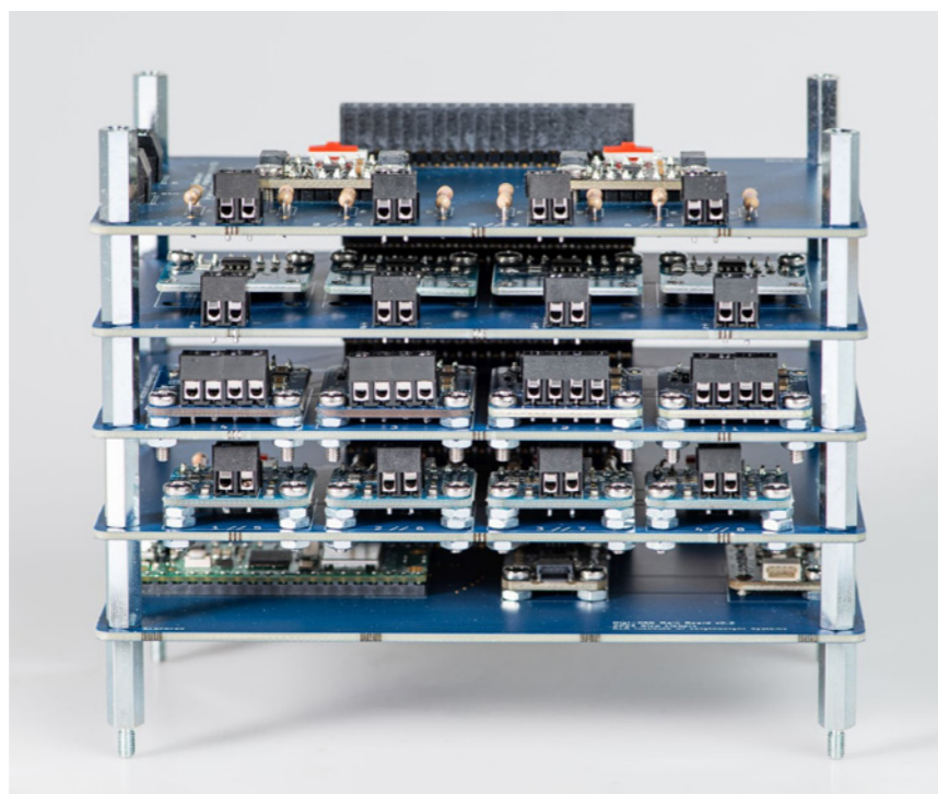
DigiDAQ mit Messmodulen für Umgebungsbedingungen, Thermoelemente, Widerstandsthermometern, analoger elektrischer Spannung und Stromstärke
