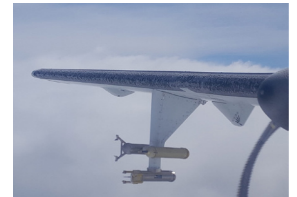
Eisansammlung an einer Vorderkante während des Flugs Ice accumulation on a leading edge during flight
