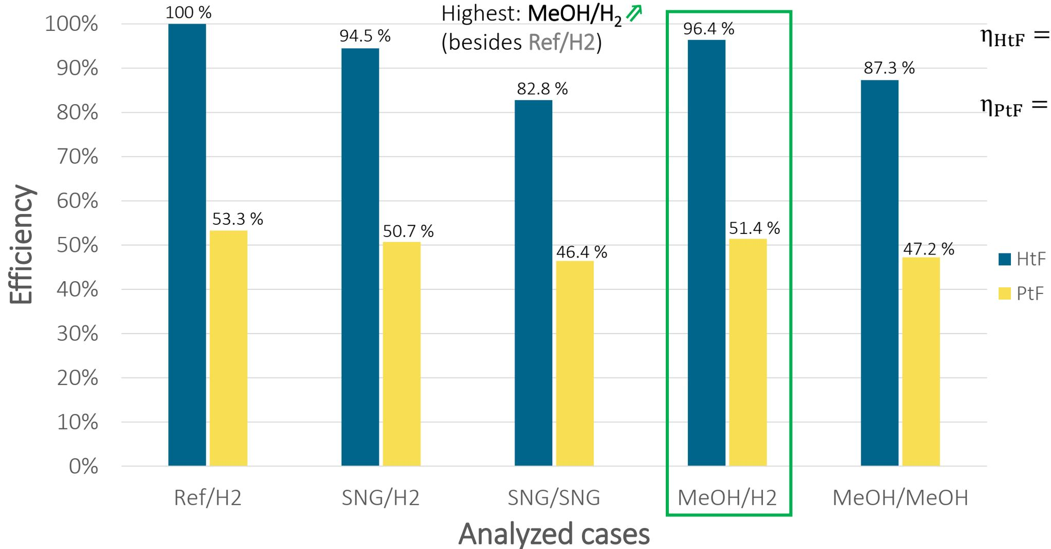
$$\eta_{HtF} = \frac{LHV_{Fuel} \cdot \dot{m}_{Fuel}}{LHV_{H_2} \cdot \dot{m}_{H_2}}$$
