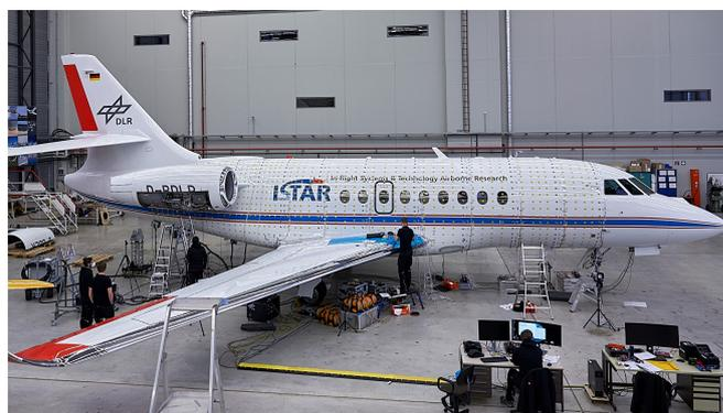
**Abbildung 1:** Das DLR ISTAR mit installierter Sensorkonfiguration C1. Das gesamte Messgitter ist auf dem Rumpf durch abnehmbare Aufkleber markiert. © 2022 DLR
