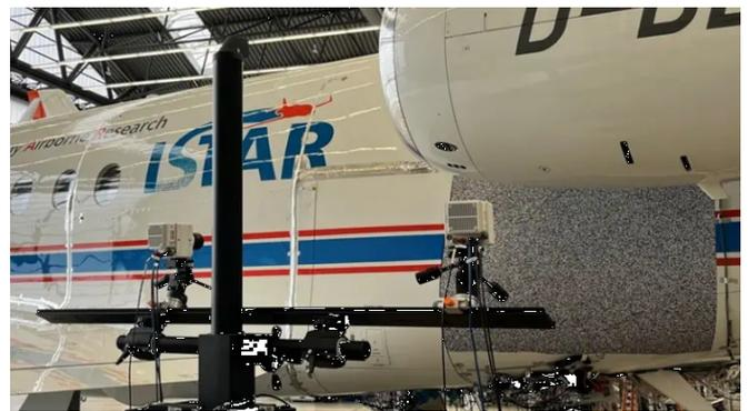
**Abbildung 4:** Das DIC System im Einsatz am ISTAR. Das aufgebrachte Muster unterhalb des Triebwerks und das Stereo-Kamerasystem sind deutlich zu erkennen. Gemessen wurde auf einer Fläche von 1,5 m x 1,5 m mit einer Auflösung von 4 MP und 2000 fps.
