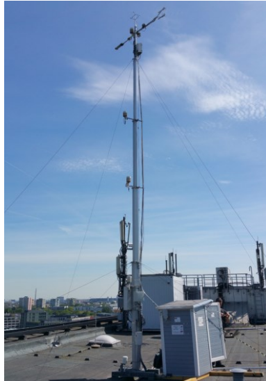
Abb. 3.7.5: Messstandort der größenklassifizierten Partikelflussmessung auf dem Dach des Hauptgebäudes der TU Berlin. Foto: Agnes Straaten (TUBSgeo).
