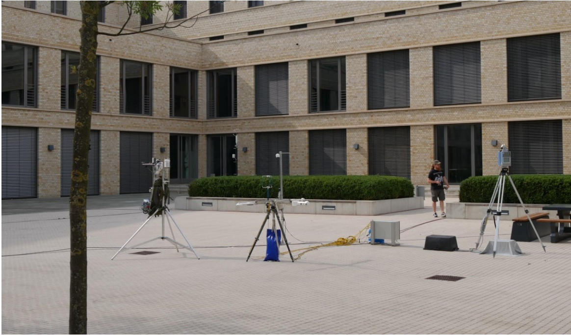
Abb. 3.6.3: Biometeorologische Station der TUBklima auf dem Schulhof des Oberstufenzentrums Körperpflege in Berlin (Bildmitte) mit Thermalscanner (rechts) während einer Vergleichsmessung mit der mobilen Plattform (Rucksack) der TUDD (links). Foto: Ronald Queck (TUDDmeteo).
