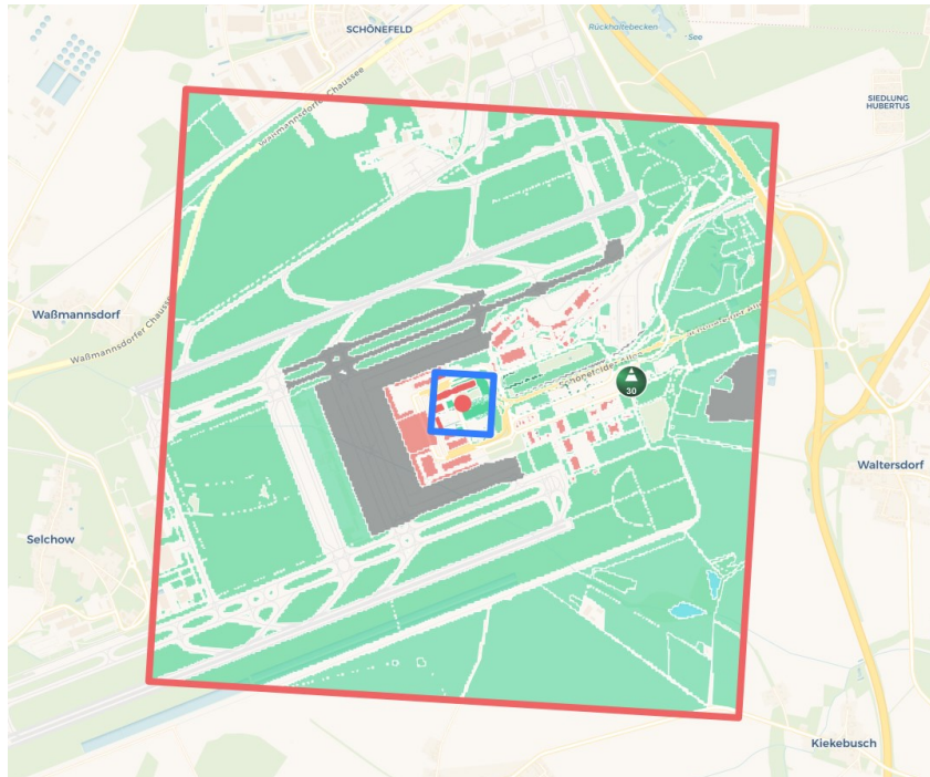
Abb. 2.3.1: Visualisierung des mit der PALM-4U GUI erstellten statischen Treibers. Der rote Rahmen kennzeichnet die parent domain (4000 m x 4000 m) und der blaue Rahmen die child domain (400 m x 400 m). Vegetationsflächen sind in grün gekennzeichnet und Gebäude in rot. Graue und weiße Areale sind Asphaltflächen. Quelle: J. Heusinger (TUBSgeo).
