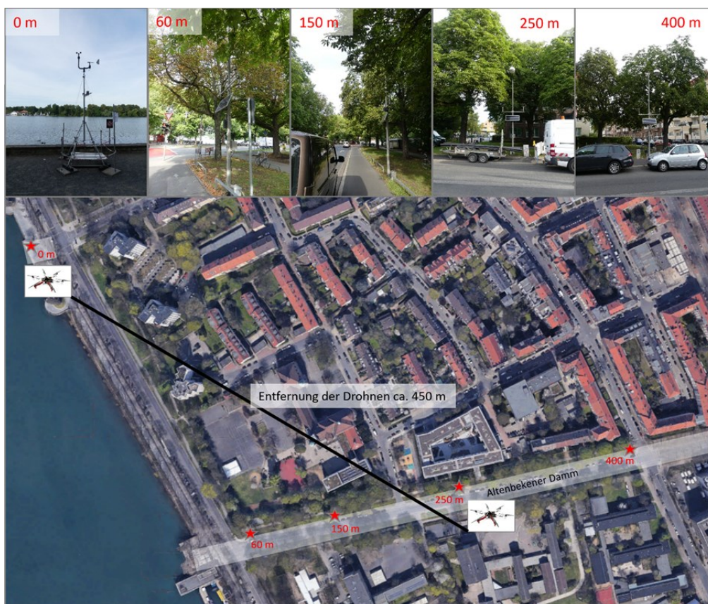
Abb. 2.3.10: Standorte der Sondermessungen, bestehend aus einer Theodor-Friedrichs-Station am Maschsee, vier Thiess-Stationen an Straßenlaternen im Altenbekener Damm sowie zwei Drohnen DJI Flamewheel 550 mit angehängter Radiosonde DFM-06 von GRAW. Quelle: Gregor Meusel (LUHimuk).
