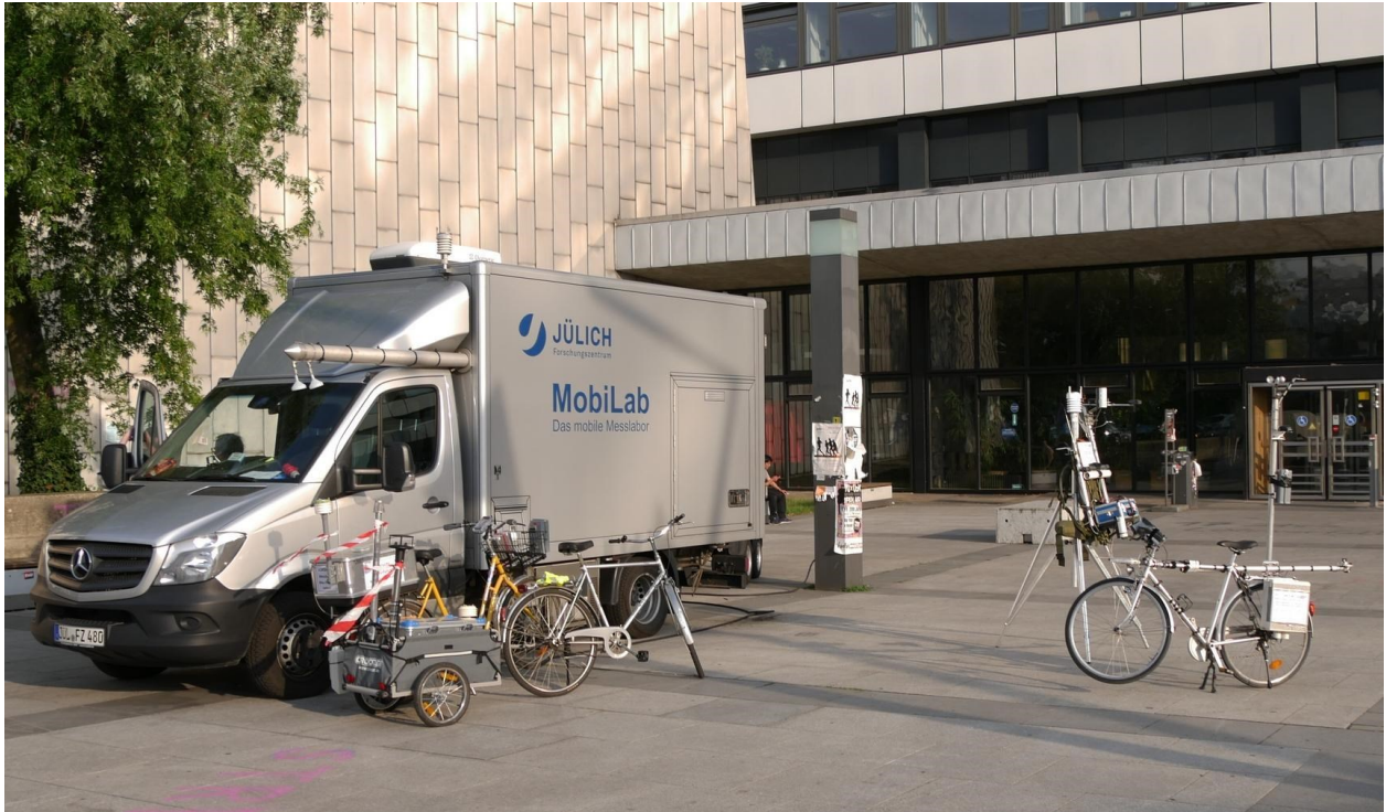
Abb. 3.6.6: Vergleich zwischen den in Berlin eingesetzten mobilen Messplattformen vor dem Hauptgebäude der TU Berlin, von links nach rechts: MobiLab des FZJiek8, Messfahrräder der TUBSgeo, Rucksack und Messfahrrad der TUDDmeteo. Foto: Ronald Queck (TUDDmeteo).
