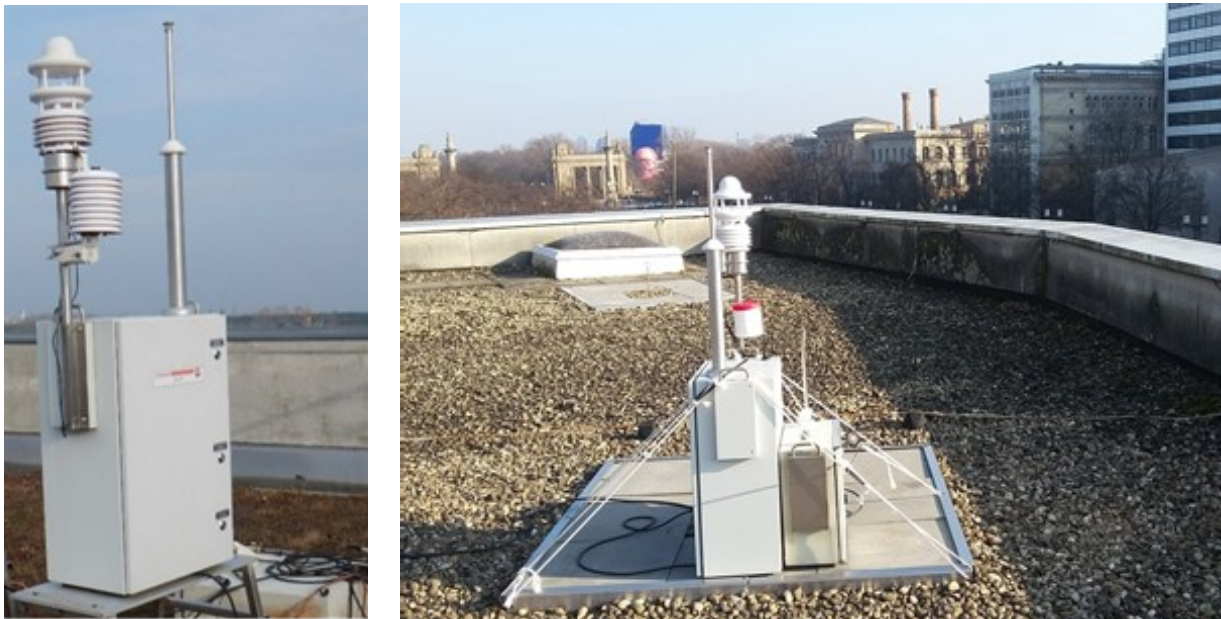
Abb. 3.7.3: Links: Luftqualitätsmessstation für Ultrafeinstaub der LTO 'Berlin-Adlershof' mit GRIMM EDM 465 UFPC, LUFFT WS600 und Minikin RTHi/QTHi; Foto: Sabine Fritz. Rechts: IOP-Standort 'tumathsouth' während IOP-1 und -2 mit GRIMM EDM465 UFPC, LUFFT WS600, GRIMM 1.109 und Stickstoff-Passivsammler. Foto: Janani Venkatraman Jagatha (HUBgeo).
