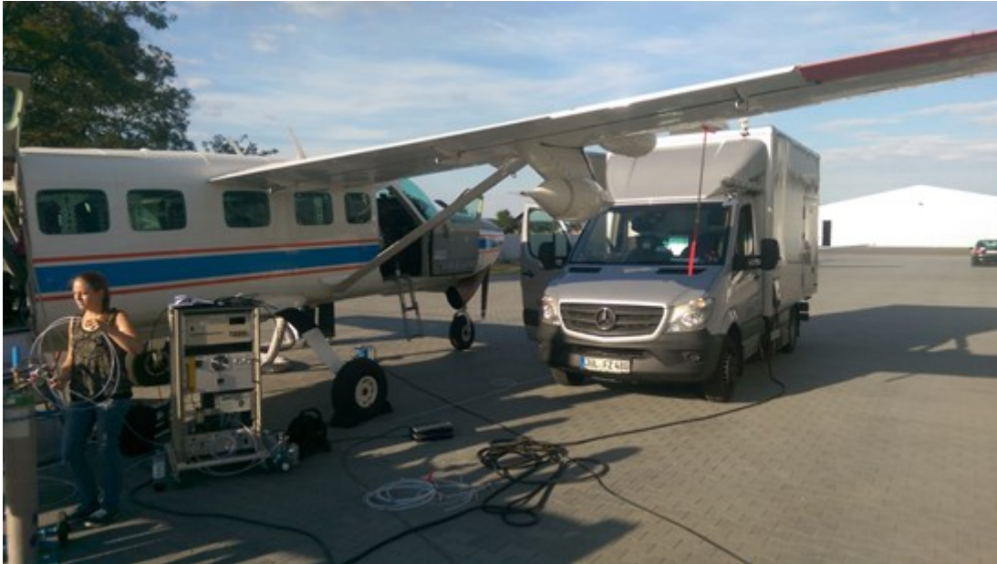
Abb. 3.7.10: Vorbereitung zum Außenluftvergleich auf dem Flughafen Schönhagen (17.07.2018). Beide Ansaugsysteme sind in unmittelbarer Nähe zueinander positioniert (Cessna: AIRPOD unmittelbar unter dem rechten Flügel; MobiLab: Ansaugung am Kopf des Aerosol-Einlasses). Durch geeignete Positionierung der beiden Systeme wurde sichergestellt, dass Kontaminationen infolge von Eigenemissionen der Messplattformen vermieden werden konnten (Windströmung von rechts). Foto: Dieter Klemp (FZJiek8).
