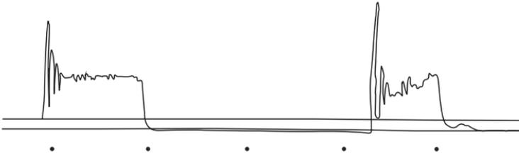
Abbildung 2.1.: Druckschrieb mit Auftreten des Abriss der Flüssigkeitssäule [31]
