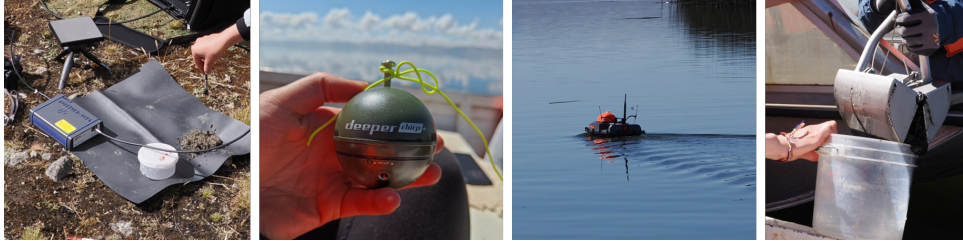
Abb. 11: Von links nach rechts: Feldspektrometer mit Referenzpanel, Sonar für punktuelle Messungen, ferngesteuertes Boot mit Sonar, Sedimentgreifer.
