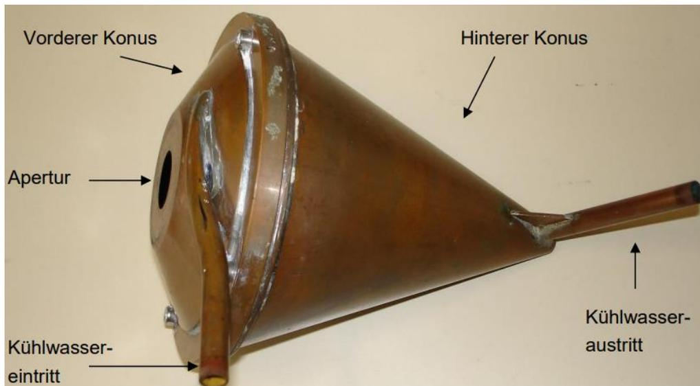
Abbildung 14: Der Absorber vom SunCatch I [8]
