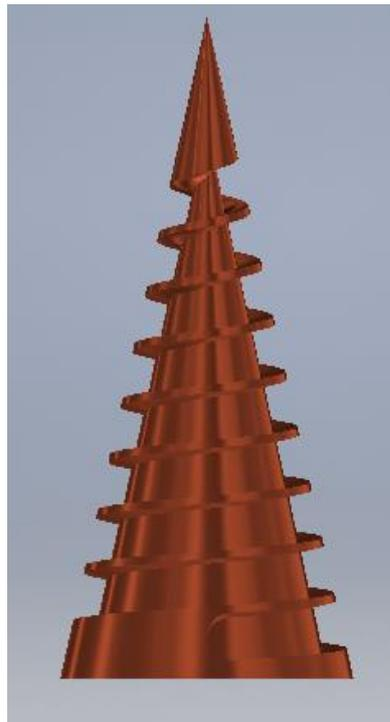
Abbildung 26: Die integrierten Wasserkühlkanäle [Eigene Darstellung]
