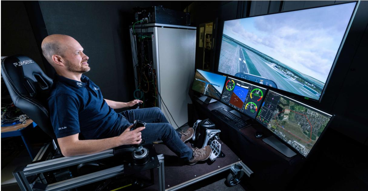
Abbildung 5.1.: First-Person-View Ground-Control-Station
