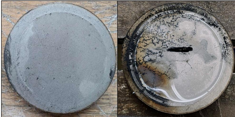
Abbildung 35: Rückseiten einer normalen (links) und beschädigten (rechts) Empfängerplatte (eigene Aufnahmen)
