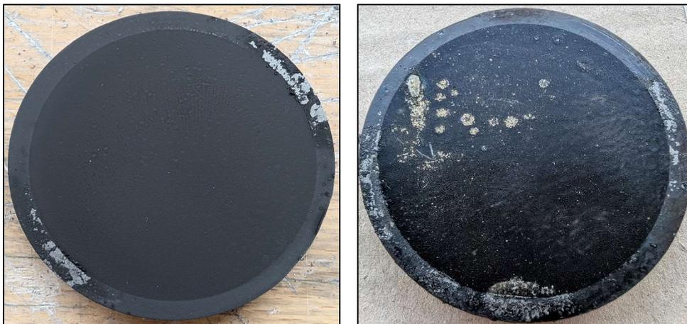
Abbildung 34: Beschichtungen der Empfängerplatten mit Thermolack (links) und Pyromark (rechts) nach dem Einsatz (eigene Aufnahmen)
