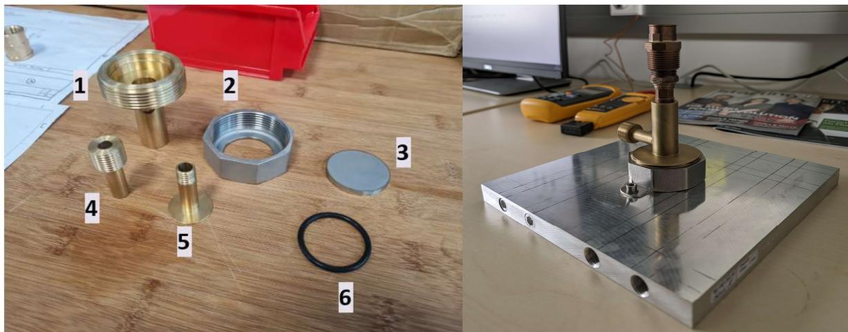
Abbildung 10: Kalorimeter in Einzelteilen (links) und zusammgebaut inkl. Kühlkörper (rechts) (eigene Aufnahme)
