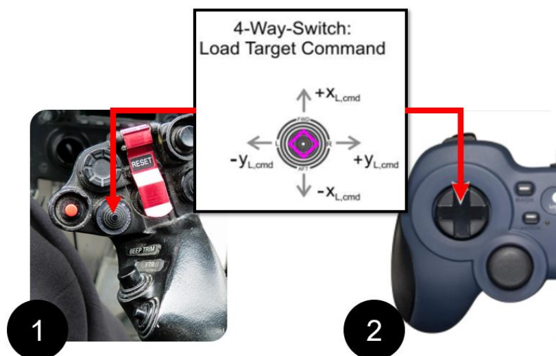
Abbildung 13: HMI Schnittstellen zur manuellen Positions Vorgabe der Außenlastposition: 1. Zyklisches Steuer des Piloten, 2. Winchdevice des Windenoperators
