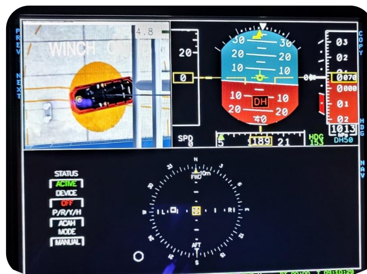
Abbildung 14: Multifunktionsdisplay des Außenlastassistentensystems: Außenlastkamera (links oben), Primary Flight Display (rechts oben), Lastpositionierungsdisplay (unten)
