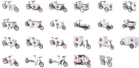
Die Projektflotte beim Lastenradtest war bewusst heterogen gewählt: 152 Fahrzeuge in fünf Bauformen, insgesamt 23 verschiedene Lastenradmodelle. Unterschieden wird auch zwischen einspurigen und mehrspurigen Modellen. Beim Test glichen sich die Bewertungen für alle Modelle in einem Punkt: Fast 80 Prozent der Testteilnehmenden sahen an dem von ihnen getesteten Modell noch Optimierungsbedarf, insbesondere was die Transportkiste, die Fahrzeughandhabung und den Fahrkomfort betrifft.
