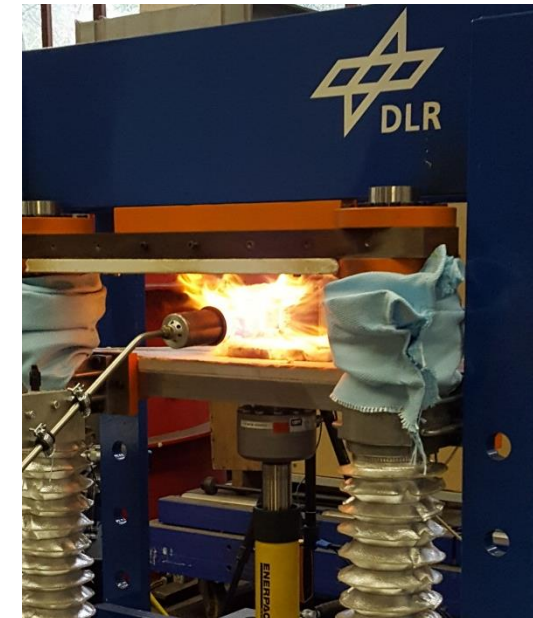
CuFex-Anlage für Brandversuche mit mechanischer Belastung
