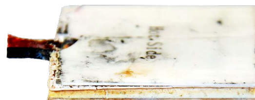
(b) Ablösung der heißseitigen Deckschicht
