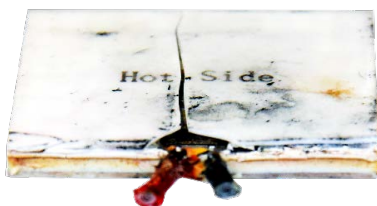
(a) Bruch der heißseitigen (Keramik-)Deckschicht
