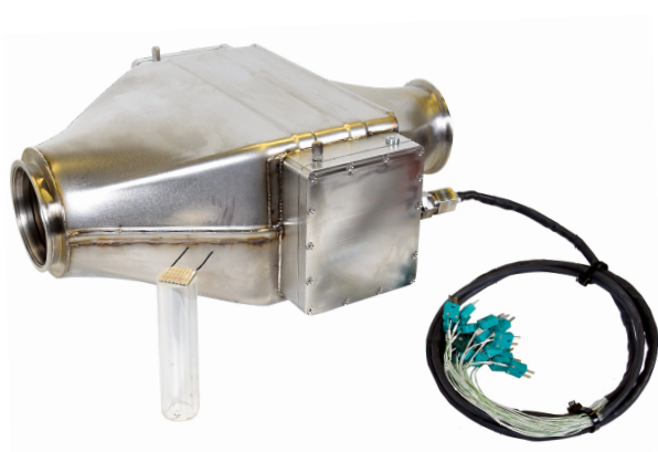
(d) TEG-Funktionsmuster mit TEM LG2-31-31-3.2
