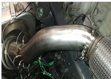
(a) Messtechnik am Abgasrohr des Turbolader-Ausgangs
