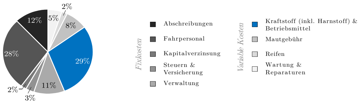
Abbildung 1.3.: Gesamtbetriebs- / TCO-Kostenstruktur eines konventionellen Sattelzuges mit Dieselmotor und einer jährlichen Fahrleistung von 150 Tkm
