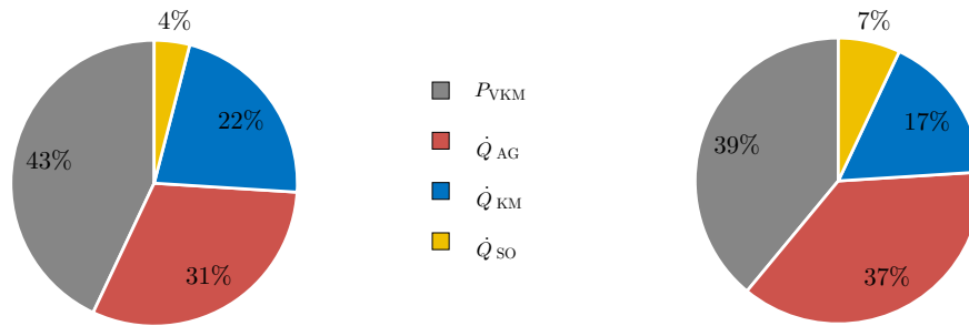
(a) Relative Verteilung der Energieströme im Diesel-NFZ (links) und Erdgas-NFZ (rechts)
