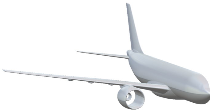
Abbildung 3.1: XRF1 als Halbmodell inklusive der UHBR-Durchflussgondel
