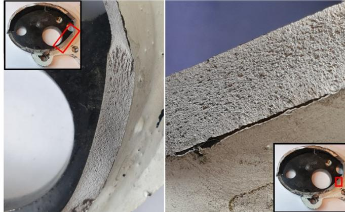
Abb. 7.25: Detailaufnahme Bereich 3, Merkmale für Sprödbbruch
