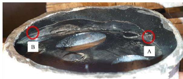
**Abb. 7.16:** Ausgebildeter Riss bei Versuchsende, Innenansicht
