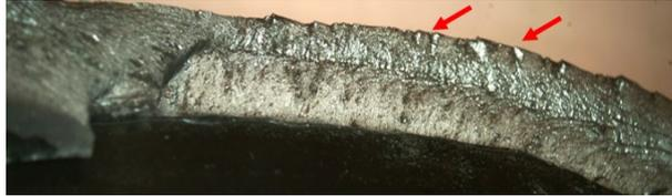
**Abb. 7.20:** Detailansicht Bereich 1, Stufen ausgehend von Schweißnahtoberfläche
