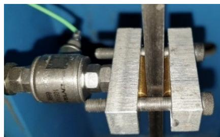
Abb. 6.3: Konstruktive Umsetzung der Lasteinleitung
