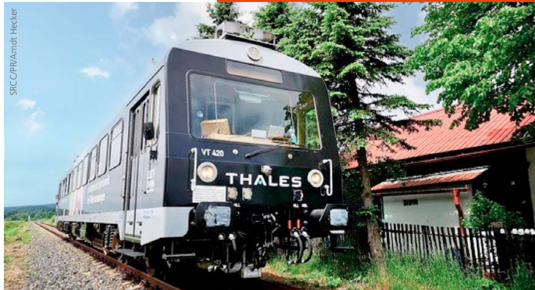
Dieser Zug kommt ohne Lokführer oder -führerin aus: Er wird über 5G gesteuert.
