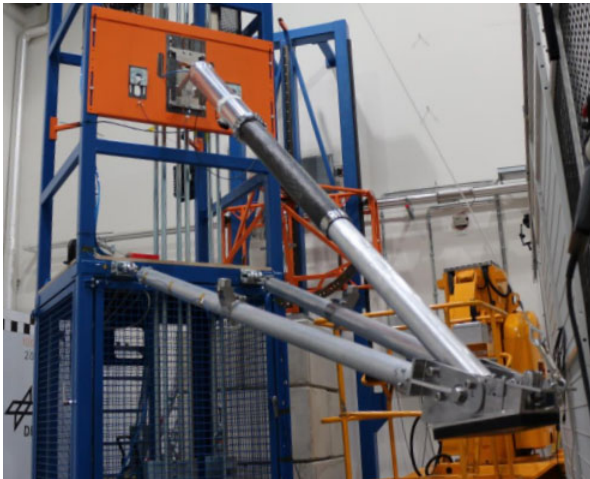
Fig. 13. ALS landing leg development model in deployed state.
