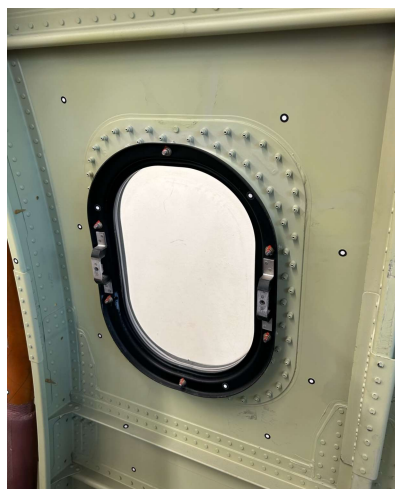
Abbildung 4.4.: Innenansicht eines Flugzeughautfeldes mit Fenster und Verstärkungsrahmen aus dem Kabinen-Mockup des DLR-Instituts für Systemarchitekturen in der Luftfahrt in Hamburg.
