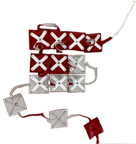
BILD 5. „Kettenspule“ mit PTFE Befestigungselementen
