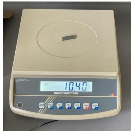
Abb. 4.3: Probe 2 vom Trägerbalken mit einem Gewicht von 10,4 g.
