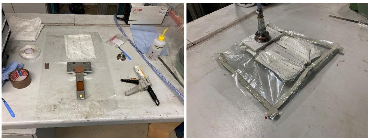
Abb. 4.17: Herstellung des Vakuumbetels. Links: Vorbereiteter Beutel mit Balken. Nachdem der Kleber „Loctite EA9466“ aufgetragen ist, wird dieser mit Dichtband geschlossen. Rechts: geschlossener Beutel.
