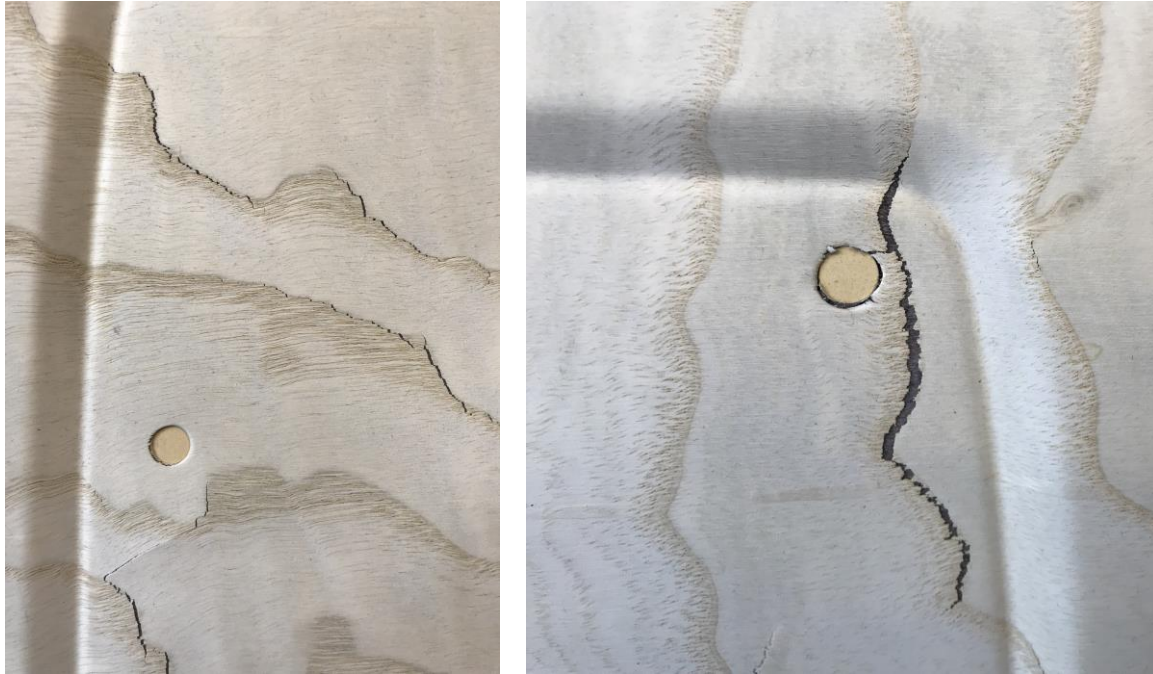
Abbildung 1.2 Risse in umgeformten Eschenholz-Furnieren durch die inhomogene Holzstruktur.
