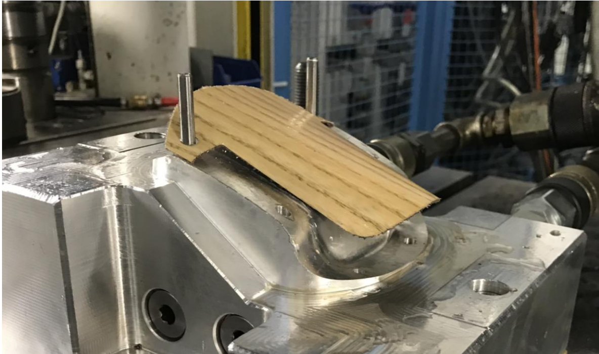
Abbildung 6.19 Ausgangsposition des Rohteils im Werkzeug vor der Umformung.
