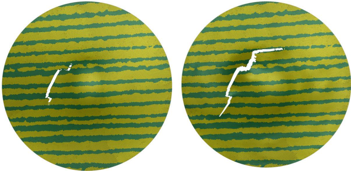
Abbildung 6.8 Rissentwicklung von Probe S245 von t_{plot}=0.0639 s zu t_{plot}=0.0673 s.
