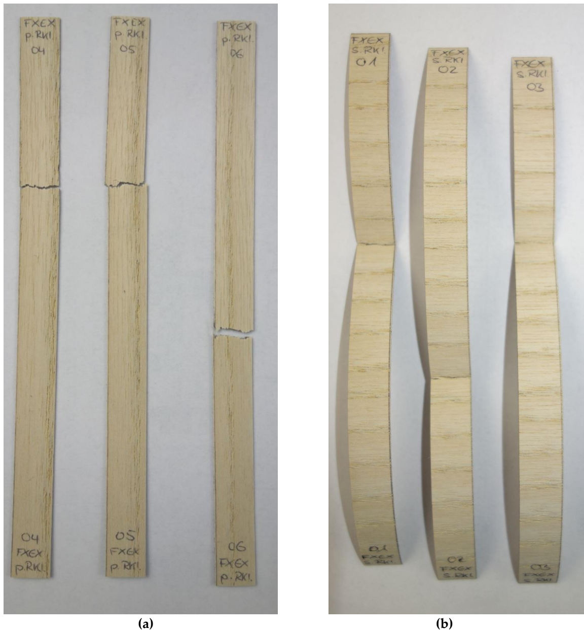
Abbildung 3.6 Bruchbilder der Zugproben parallel (a) und senkrecht zur Faserrichtung (b)
