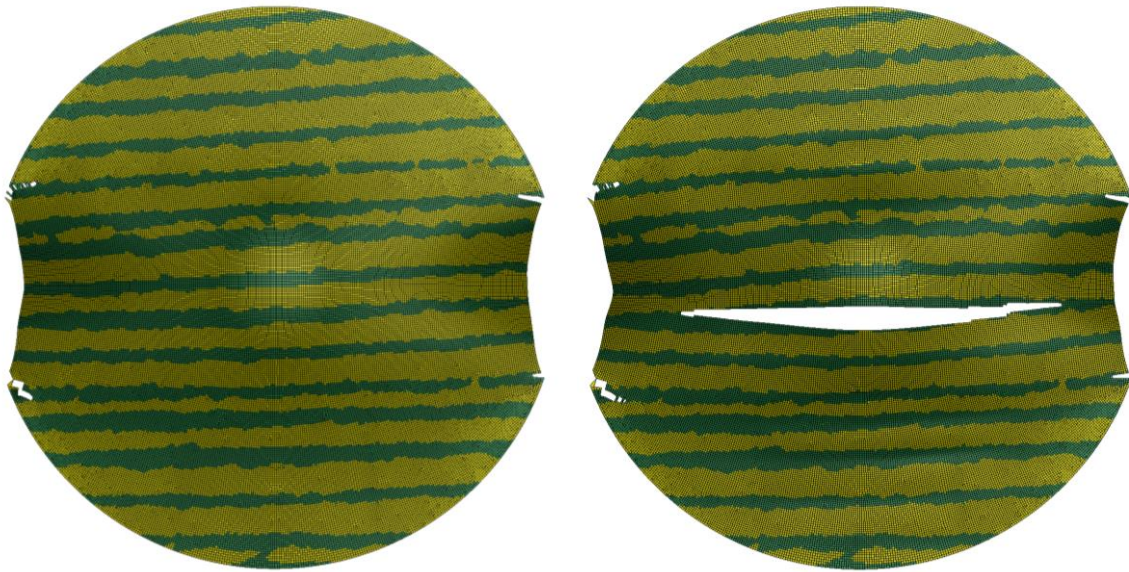
Abbildung 6.9 Rissentwicklung von Probe S125 von Plotstate t_{plot} = 0.0706 s zu t_{plot} = 0.0727 s.
