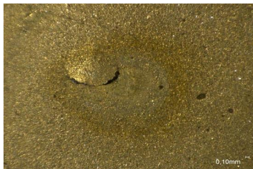
Abb. 6.10: Elektrischer Kurzschluss zwischen Aktuatorelektrode und Goldbeschichtung
