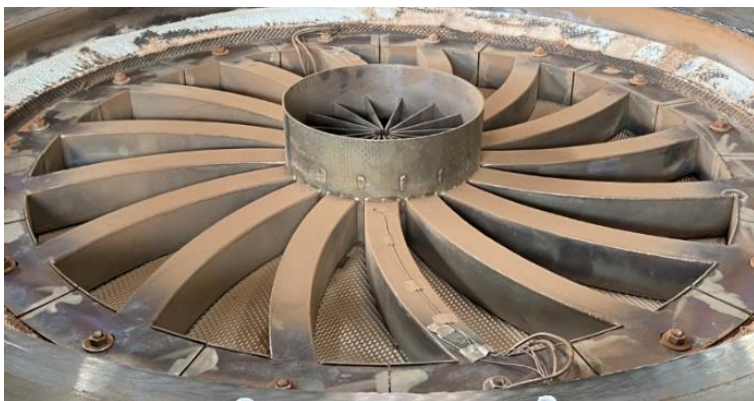
Bild 16: Bisheriges und geändertes Design der Partikelzuführung in die drehende Trommel
