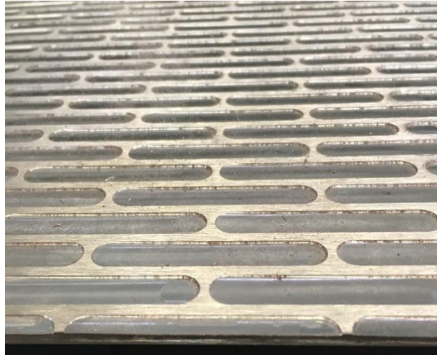
Bild 17: Gefräste Oberfläche des Inliners im CR1600T
