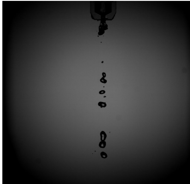
Abbildung 6: Plateau-Rayleigh-Instabilität mit Haupt- und Satellitentropfen
