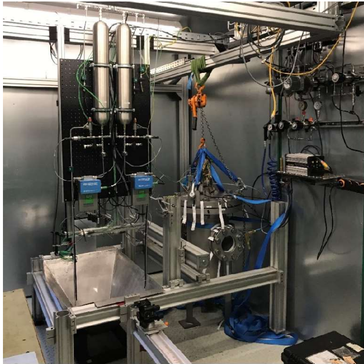
Abbildung 31: Cold-Flow-Prüfstand mit atmosphärischem Aufbau links und Versprühkammer rechts
