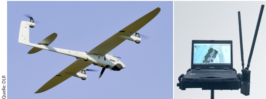
Abb. 4: VTOL-Drohne Vector mit MACS-Payload (links) und Notebook mit IP-Funkgerät (rechts) zur Visualisierung des Luftbildmosaik
