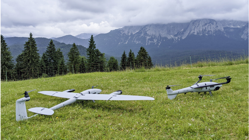
Abb. 1: Unbemannte Fluggeräte mit integriertem MACS-Kamerasystem in der Flugkonfiguration Vector (links) und Scorpion (rechts)
