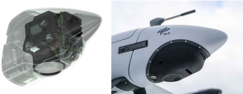
Abb. 2: CAD-Modell (links) und Aufbau (rechts) des MACS-Kamerasystems für Vector und Scorpion
