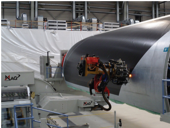
(a) ATL-Prozess eines Rumpfpanels (© Premi- um AEROTEC GmbH [51])
