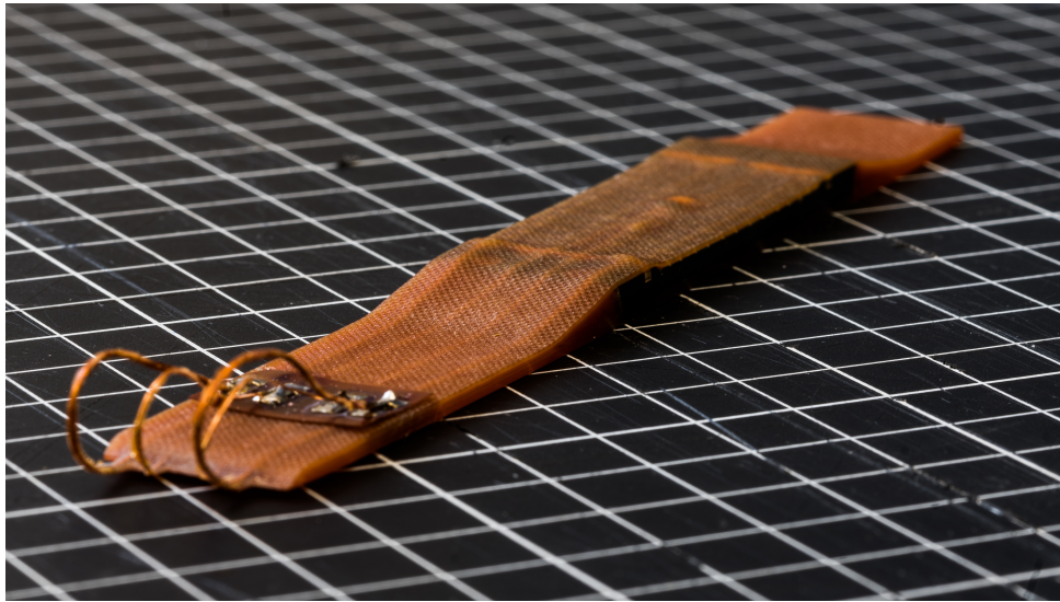
Abb. 5.5: Beispielhafte Probe #11_40451 eines einlamierten CompActive-Aktuators in HexPly ® 913
