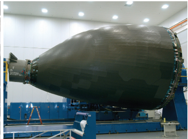
(b) AFP-Prozess der Bugsektion einer Boeing 787 (© Boeing [51])
