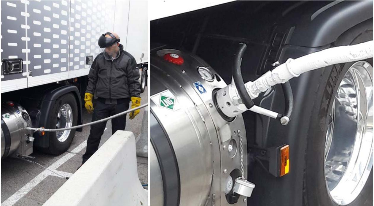
Abbildung 8: LNG-Betankungsprozess – Erdung, Gasrückführung (links); LNG-Füllkupplung (rechts)
