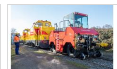
© ZAGRO Bahn- und Baumaschinen GmbH, Bad Rappenau, ZAGRO E-MAXI XXL. Rangierfahrzeug mit Elektroantrieb
