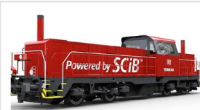
Toshiba T-HDB 800 für DB Cargo – Dieselhybrid (Quelle: eurailpress )
