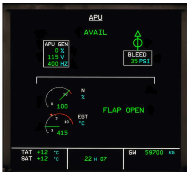
(a) ECAM-Display der APU einer A320 [10]
