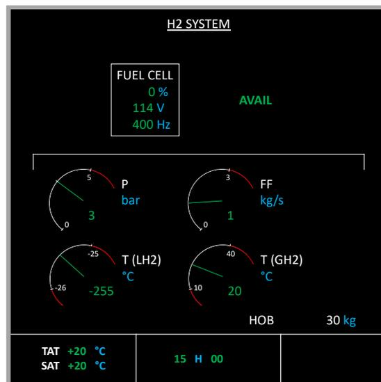
(b) Entwurf für ein ECAM-Display einer wasserstoffbetriebenen APU [60]
