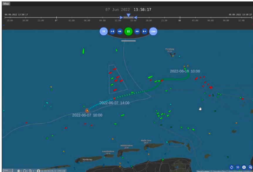
Abb. 8: Drift Visualisierung: Der rote Punkt auf der Linie markiert die Position des Driftobjektes zu diesem Zeitpunkt. In blau ist der vergangene Driftweg und in grün der zukünftige dargestellt.
