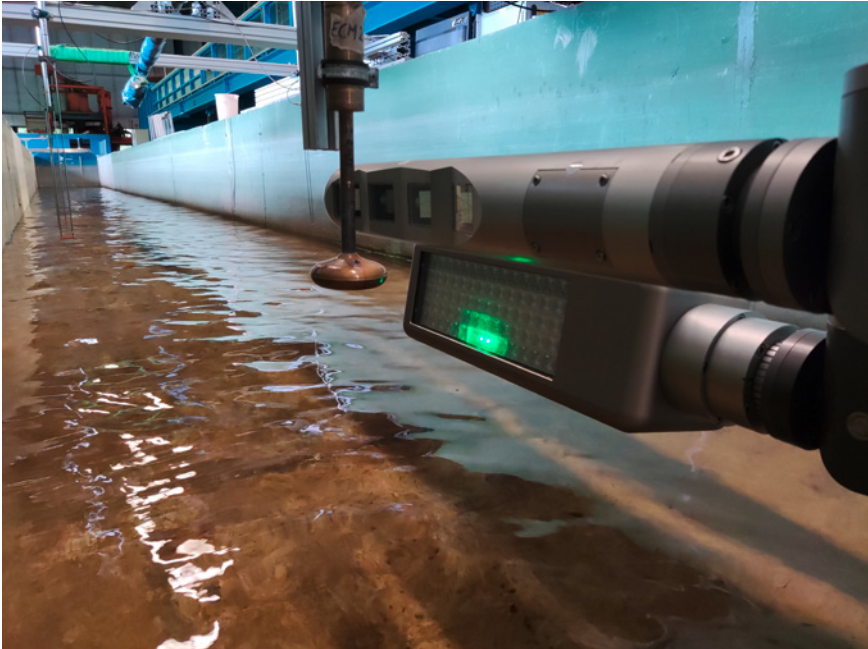
Abb. 2: Darstellung des LaVision MiniShakers (oben) und der LED (unten, grünes Licht) im 2m-Wellenkanal des Leichtweiß-Instituts für Wasserbau.
