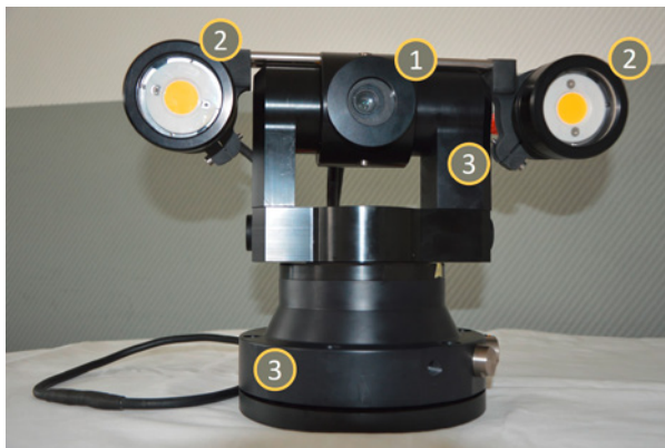
Abb. 6: Optische Kontrolleinheit mit 1 – Kamera, 2 – Beleuchtung und 3 – integrierte Motoren
