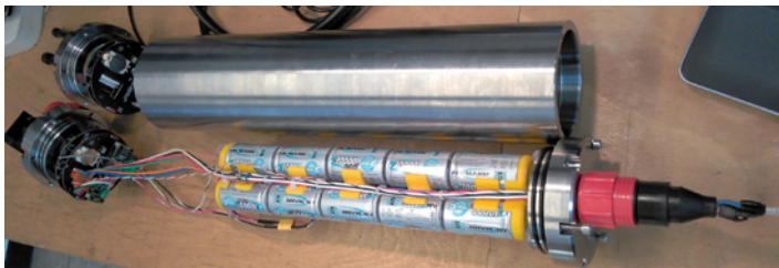
Abb. 4: Druckgehäuse, Akkupack und verschiedene Deckelvarianten des „SeaFeather 10k“-Systems
