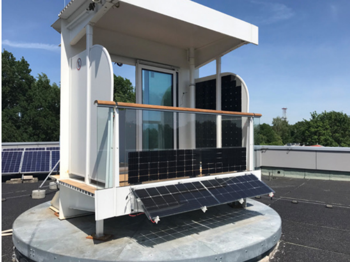
Abb. 14: Outdoor-Teststand zur Vermessung der Photovoltaikinstallation auf dem Dach des DLR Institut für Vernetzte Energiesysteme in Oldenburg. Es wurden dabei darauf geachtet die Designstudien bestmöglich zu berücksichtigen.
