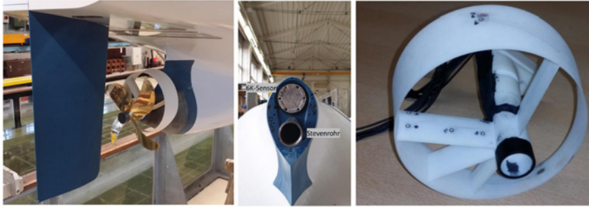
Abb. 2: Links: Anordnung der Propulsionsorgane am Versuchsträger. Mitte: Aufnahme der Kraftmesswaage für die Düse. Rechts: Düse mit Druckmesspunkten
