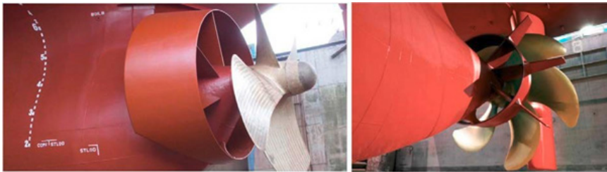
Abb. 1: Ansichten von installierten Pre-Swirl Ducts
