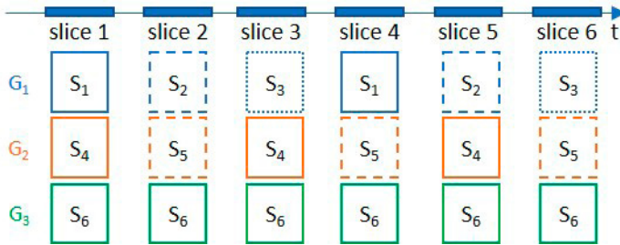
Abb. 9: Beispielhaftes Zeitmultiplex TDM für die Multisensor-Plattform. © IEEE
