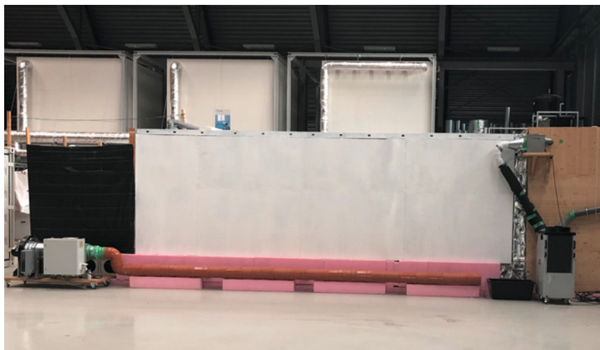
Abb. 21: Mock-Up zur empirischen Validierung der virtuellen Simulationsmodelle sowie zur Vermessung der ATU unter realen Randbedingungen in der MEGA Halle des Fraunhofer IBP am Standort Holzkirchen. Die angrenzenden Zonen, der Fußboden sowie die Außenwand sind hierfür einzeln klimatisierbar.
