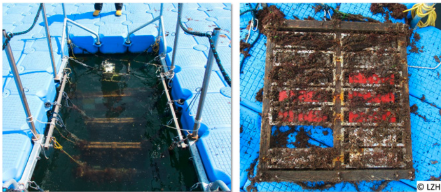
Abb. 6: Links: "Moonpool" des Schwimmpontons mit den im Wasser hängenden Probenrahmen. Rechts: Bewachsene Proben nach einer Auslagerungsdauer von fünf Monaten.
