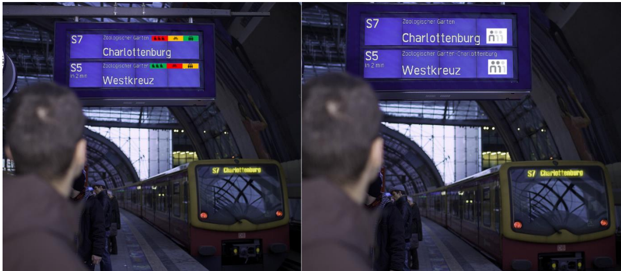
Abbildung 38 Eigene Darstellung der Echtzeitauslastung mittels DFI am Bahnsteig
