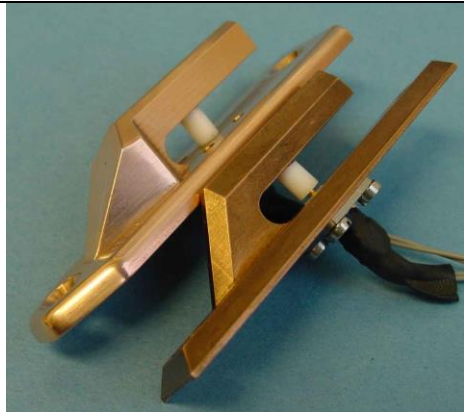
Abbildung 17 S-Band Testantennen mit Teflonummantelter Temperatursensor
