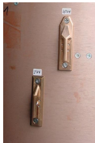
Abbildung 16 Montage der Testantennen an der Nutzlaststruktur
