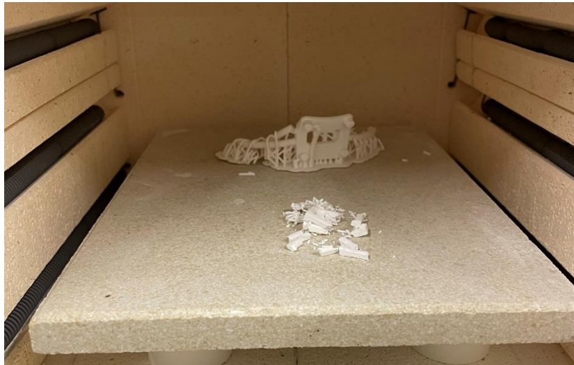
Abbildung 3-5: Fehlgelagerter Keramikbrand im inneren des Brennofens aufgrund zu hohen Polymeranteils im Werkstück
