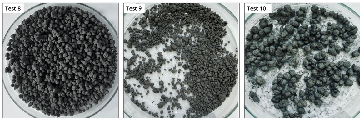
Abb. 12: Einfluss der Betriebsparameter auf die Granulatbildung. Test 8: Zeigt einheitliche grobe Partikel (>3 mm) infolge einer niedrigen Drehzahl. Test 9: Zeigt Partikel mit einer uneinheitlichen Größenverteilung infolge hoher Drehzahl. Test 10: Zeigt klumpenartige Partikel aufgrund einer langen Granulierzzeit.
