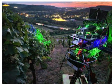
**Abbildung 12.** vinoLAS-Labordemonstrator zwischen zwei Rebzeilen bei Feldmessungen im Weinberg bei Dämmerung.
