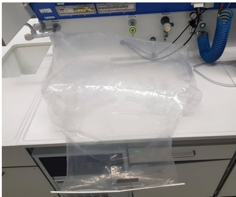
Abbildung 10: Glove-Bag für den Ionenaustausch und Einbau der MEA in die Messzelle unter Schutzgas
