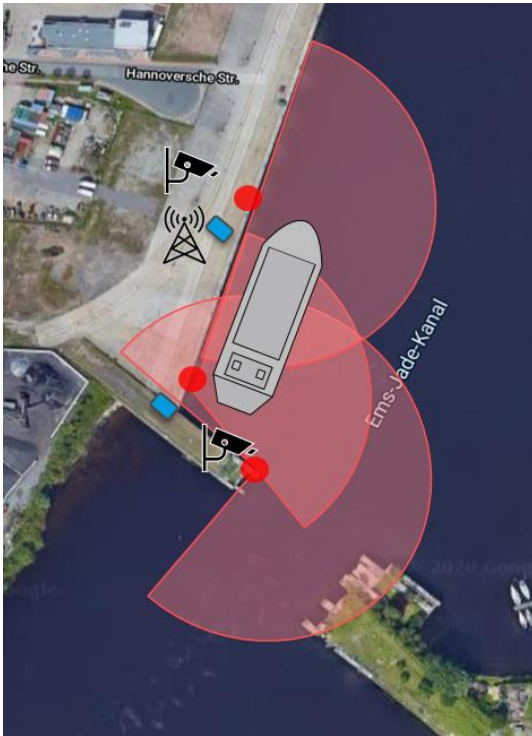
Abb. 2 links: Aufbau des Systems in Wilhelmshaven (rot Laserscanner, blau Sensorknoten) Kartendaten © Google Earth 2020; rechts: Scandaten mit Schiff im Beobachtungsbereich
