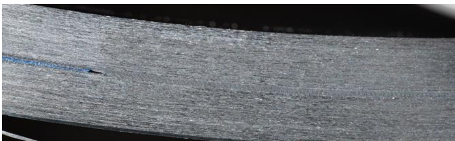
Abbildung 17: Belasteter Prüfkörper mit PVDF als Reinsubstrat
