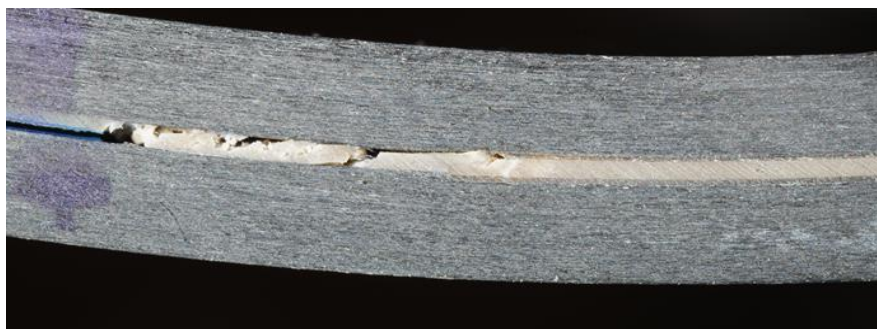
Abbildung 14: Rissfortschritt bei einem ENF Prüfkörper mit eingebrachtem ST Streifen
