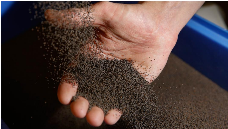
Bild 9: Bauxit-Partikel von ca. 1 mm Durchmesser bei Untersuchungen am DLR, [54]
