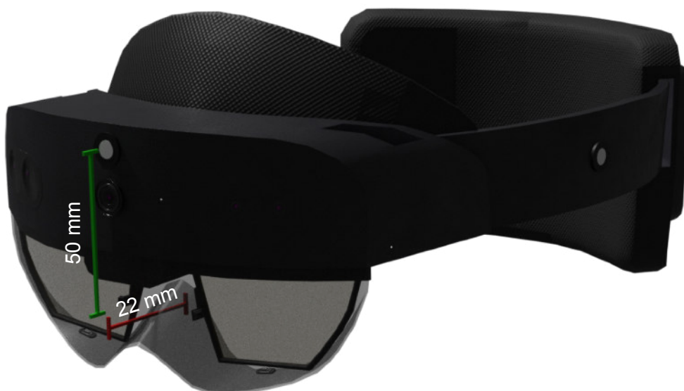
Abbildung 6.4.: Lage des Ursprungs des KS_{HL} in Bezug zu den verwendeten Photogrammetriemarkern
