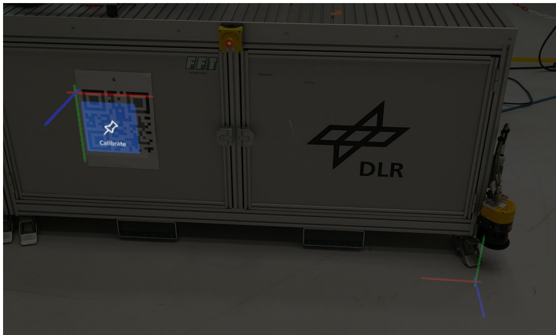
Abbildung 5.1.: Virtuelle Schaltfläche auf dem QR-Marker und Visualisierung des raumfesten Koordinatensystems KS_{MZ}
