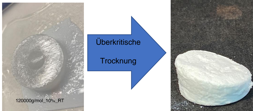
Abbildung 12 Links: gebildeter Gelkörper; Rechts: Überkritisch getrocknetes Aerogel
