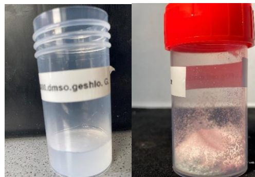
Abbildung 18 Einfluss der M.G. auf die Aerogel Struktur von der Probe 9, (30417 g.mol -1 /10 Gew.-%/Gelierung bei 50 °C, links: Gel-Zustand, rechts: Aerogel-Struktur).
